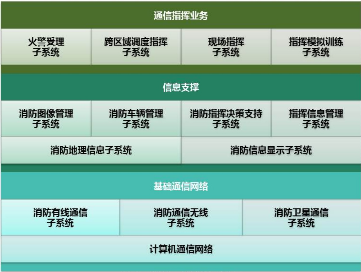
消防通信指挥系统的技术构成
