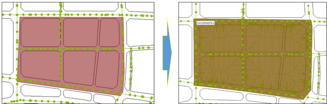
图 3-12 Infoworks 集水区细分示意图
